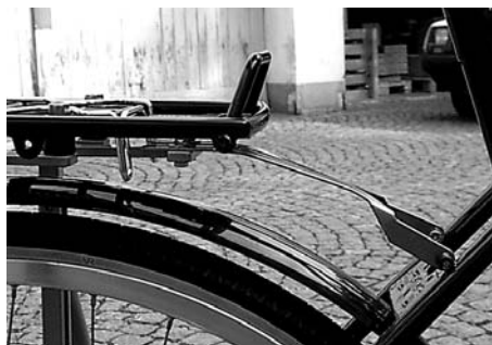
(Abb. 1) Montage des Grundträgers mit den Pletscher-Befestigungslaschen für an die Rahmenösen. Je nach Velotyp müssen die Befestigungen an die Stegplatte oder den Bremsbolzen verwendet werden.
